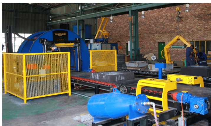
Sekundarna regeneracija peska, 90 % ponoven izkoristek
